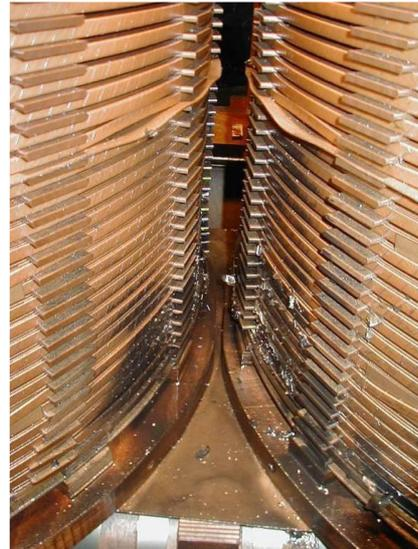
**Figure 4.5.** Amorçage entre enroulements
