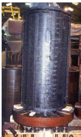
**Figure 4.8.** Echauffement excessif d'un enroulement
