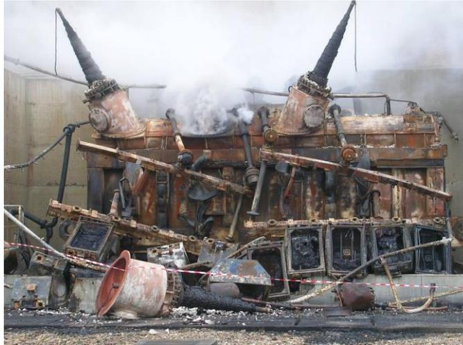
**Figure 4.3.** Explosion de transformateur
