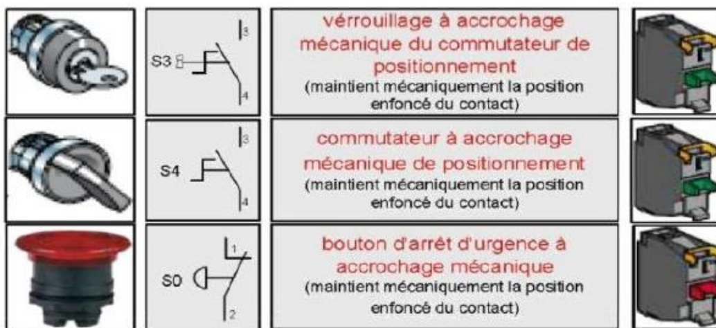
Figure : Etats des interrupteurs commutateurs
